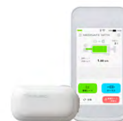
専用リモコンをスマートフォンタイプへ リニューアルしたパッチ式インスリンポンプ 「メディセーフウィズスマート」
