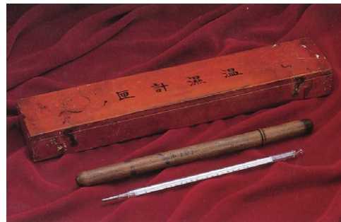
テルモの歴史を刻んでいる基準器(1923年ドイツ製。温度を正確に計るとき、その基となる基準ガラス製温度計)
