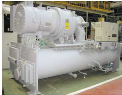
高効率ターボ冷凍機 (甲府工場)
