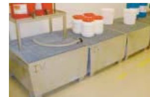
化学物質管理 容器が載っている台は上部が網の目状になっており、薬品がもれても汚染の拡散を防ぎます。
