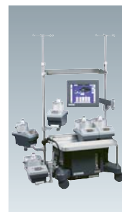
人工心肺装置 心臓の代わりに体内に血液を循環させます。
